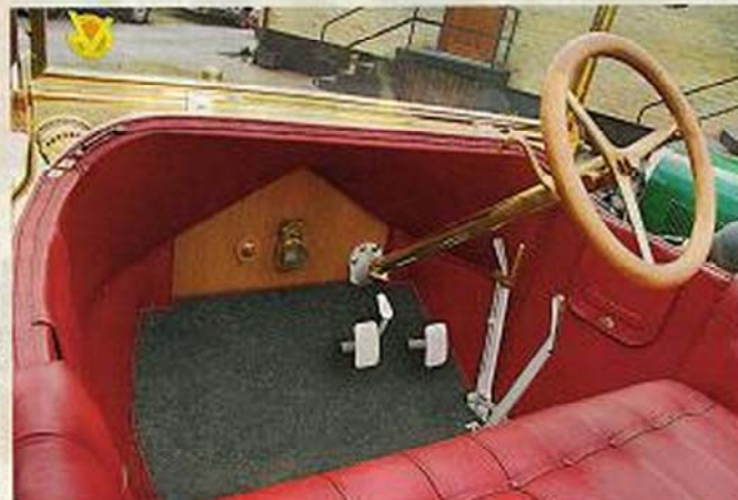
Förarmiljön är begriplig. Handbroms enbart på bakhjulen, bromsar fram saknas. På torpedväggen ett fönster för kontroll av motorns smörjning.
