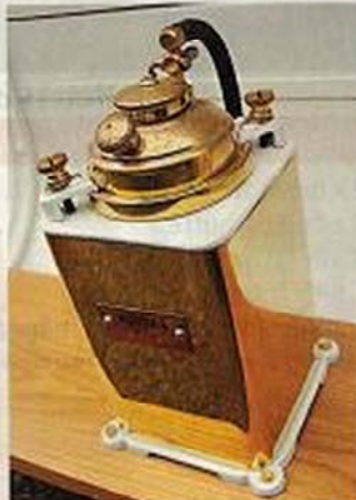
I karbidtanken bildas acetylen som leds i slangar till lyktorna fram.
