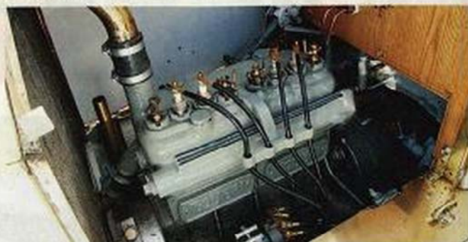
Fyrcylindrig motor på 14 hk. Bredvid tändstiften syns de små ventilreglerade "snappskälarna" där en slurk bensin hälldes innan motorn revades igång.
