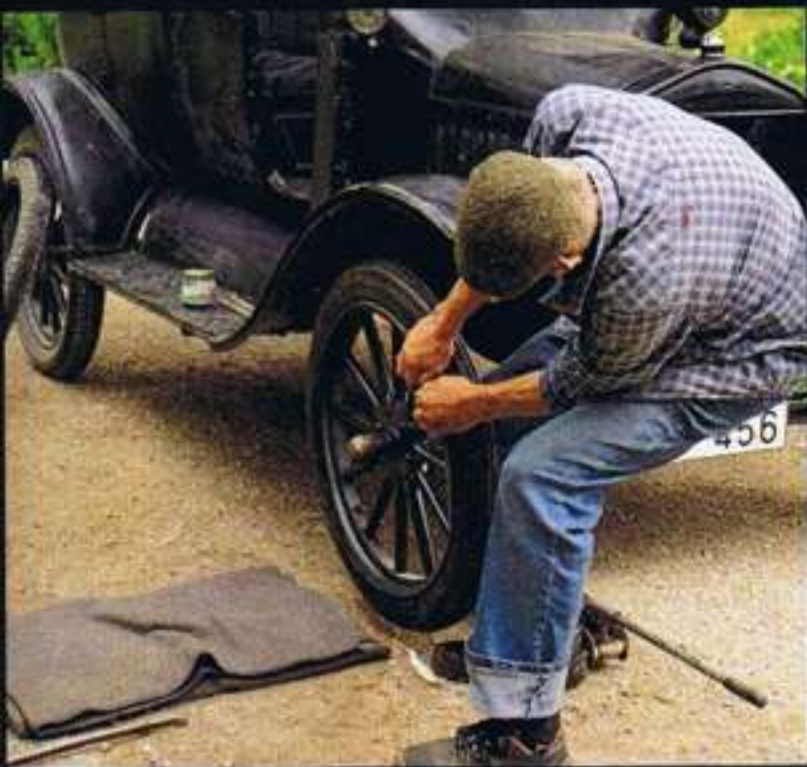
Vränga av var lättare än att vränga på. Till sist är både slang och vulstdäck på plats.
